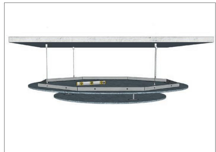
A l'aide d'un niveau, régler la hauteur du concept.
