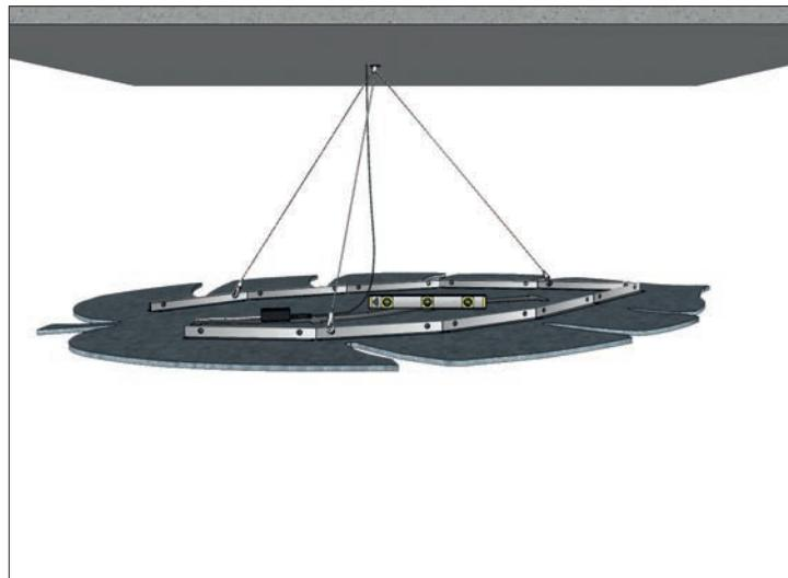
À l'aide d'un niveau, régler la hauteur et l'inclinaison du panneau à convenance.
