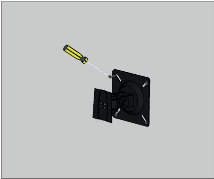
Repérer le placement des vis, choisir la qualité des chevilles et des vis selon le mur, puis fixer le support orientable.
