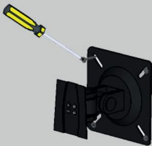
Repérer le placement des vis, choisir la qualité des chevilles et des vis selon le mur, puis fixer le support orientable.
