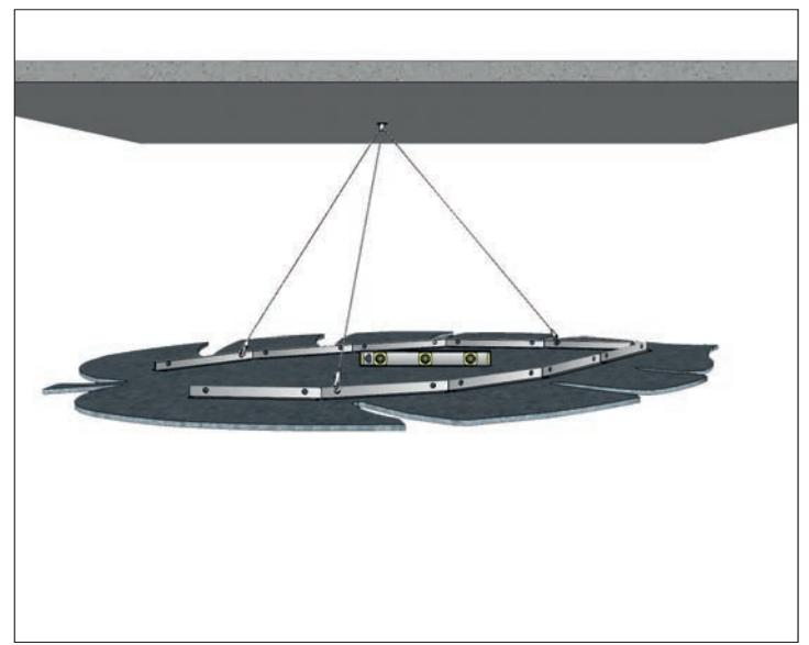
À l'aide d'un niveau, régler la hauteur et l'inclinaison du panneau à convenance.
